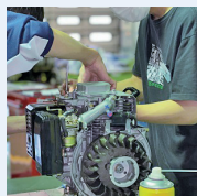
エンジンのオーバーホール
