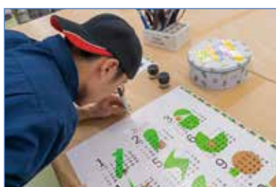
⑤色調調整、品質管理：テスト印刷をし、印刷位置や色の濃さを調整します。
