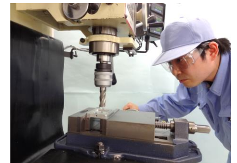
フライス盤による部品加工作業の様子
